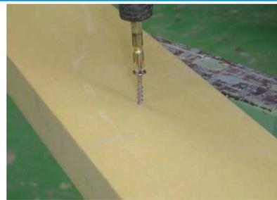
硬質発泡ウレタンをマトリックスに用いた広義のFRP(繊維強化プラスチック)です。高強度・腐食しない・電気絶縁性がある といったプラスチックの特徴と、水に浮くほど軽く・釘が打てる・貼り合わせが可能 といった木材のような特徴を合わせ持ちます。不飽和ポリエステル樹脂との密着性も良好で、合板の代替や芯材としてご利用いただけます。
